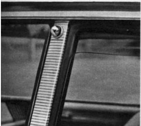
Oben ist die Fensterabdichtung (ohne Rahmen, an breiten Gummiprofilen), unten die Fugenordnung Kotflügel/Motorhaube/Vordertüre erkennbar.
