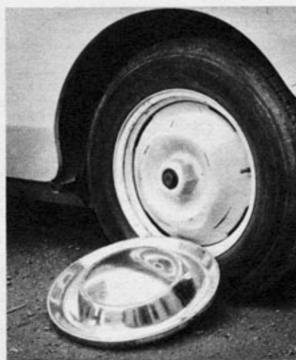
Nach Abnehmen der Radzierkappe erkennt man den Zentralverschluss des Rades.
