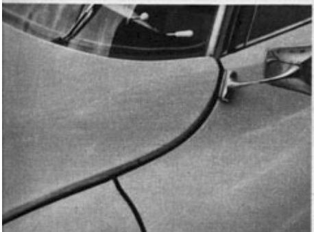
Oben ist die Fensterabdichtung (ohne Rahmen, an breiten Gummiprofilen), unten die Fugenordnung Kotflügel/Motorhaube/Vordertüre erkennbar.
