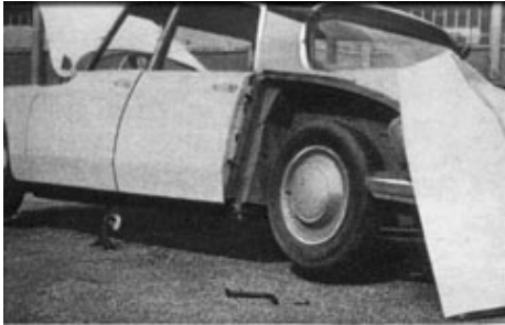
Entsprechende Niveaueinstellung ermöglicht mit Hilfe eines Stützbocks sogar den Radwechsel. Der Hinterkotflügel muß abgenommen werden.
